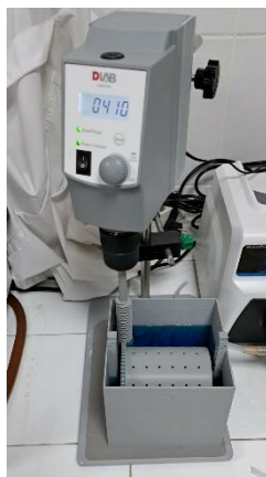
Fig. 7. Subsistemul pentru producerea \text{CuSO}_4 folosind sistemul redox \text{SO}_4^{2-}/\text{S}_2\text{O}_8^{2-} .
