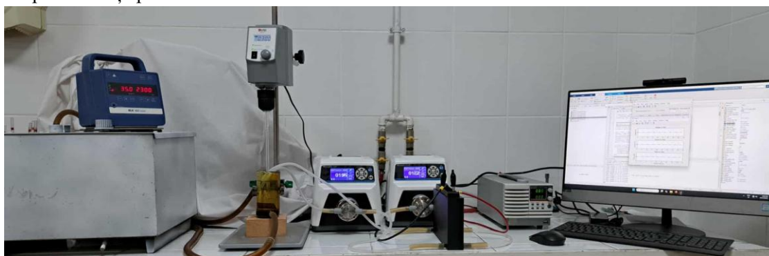
Fig. 8. Subsistemul pentru producerea \text{CuSO}_4/\text{Cu} și regenerarea agentului de leșiere.
