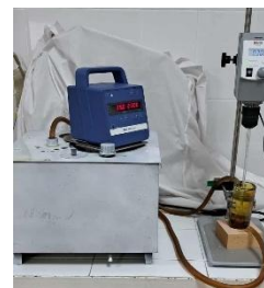
Fig. 7. Subsistemul pentru producerea \text{CuSO}_4 folosind sistemul redox \text{SO}_4^{2-}/\text{S}_2\text{O}_8^{2-} .
