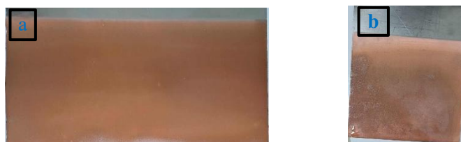
Fig. 10. Depozitului de Cu format pe catodul de aluminiu (a) respectiv catodul de oțel inoxidabil (b).
